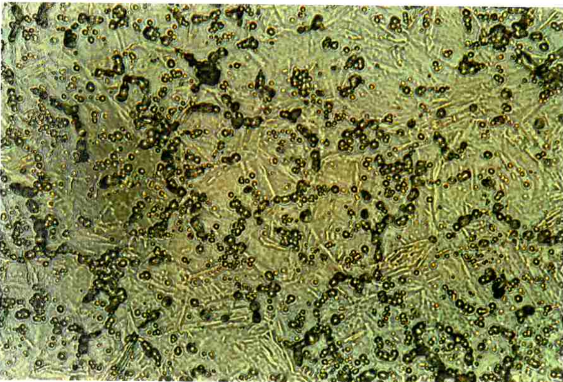
Fig.1: Microestrutura do aço AISI 420 austenitizado a 1010°C e temperado em óleo após ataque com ácido oxálico. (a)Aumento 200X.(b) Aumento 250X.
